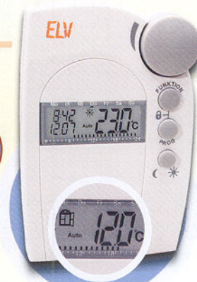
Automatische Absenkung der Temperatur bei geöffnetem Fenster
