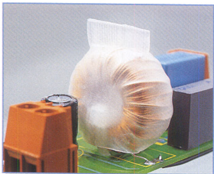
Bild 28: Montage der Drossel mit Kabelbinder und Schrumpfschlauch
