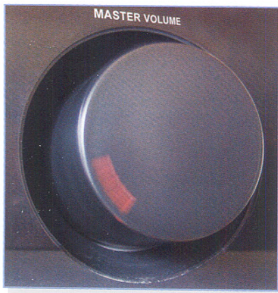
Bild 1: Per Fernsteuerung befehligt, mechanisch gedreht – motorisch angetriebener Lautstärkeeinsteller einer hochwertigen HiFi-Anlage. Deutlich ist in der Zeitaufnahme die ausgelöste Drehbewegung am Weg der roten Markierung zu erkennen.
